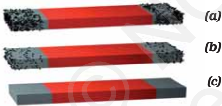
चित्र 13.6 चुंबक (a) पर्याप्त लोहे के बुरादे के साथ (b) कुछ बुरादे के साथ (c) बिना बुरादे के साथ
